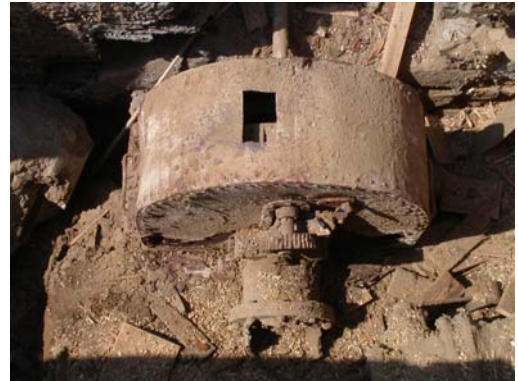
Girard Turbine, eingebaut 1897
